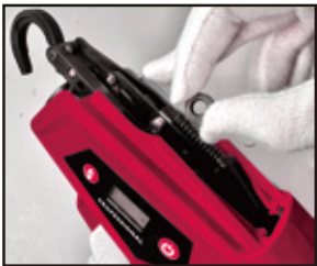
7. Αντικαταστήστε τον ελαστικό τροχό με νέο. Βεβαιωθείτε ότι η υποδοχή του ελαστικού τροχού κοιτάζει προς τα έξω.
